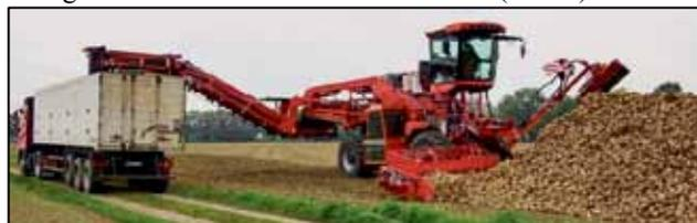
Er kann Rüben aus einer Miete mit bis zu 9,5 m Breite aufnehmen, reinigen und verladen. Der Befüllvorgang des Transporters wird über Laserkameras erfasst und vollautomatisch gesteuert.
